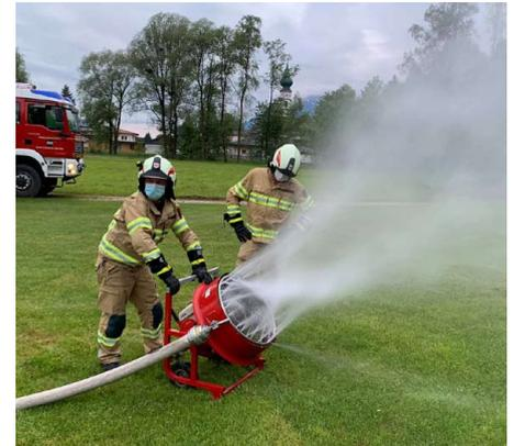
**Der Drucklüfter** wurde durch Gerätewart Gerhard Auer mit einem Sprühring ausgestattet. Dieser kann im Einsatzfall die Löscharbeiten enorm erleichtern.
